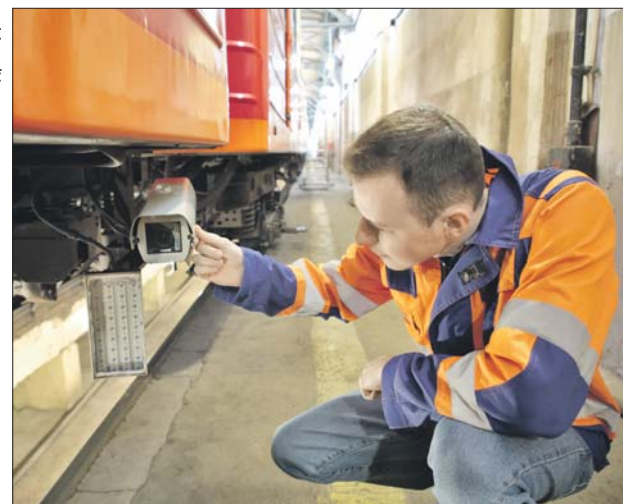
Состояние путей фиксирует видеокамера под вагоном
