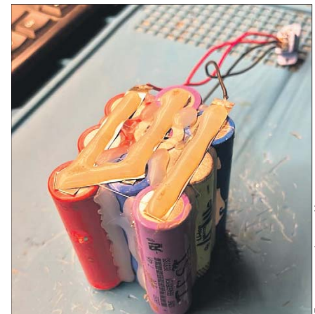
Так выглядит самодельная аккумуляторная сборка для зарядки электронных устройств, необходимых на передовой
