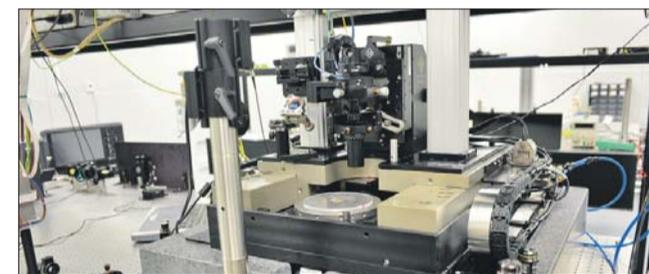
На таком оборудовании с помощью фемтосекундного высокоточного лазера информацию записывают на диск
