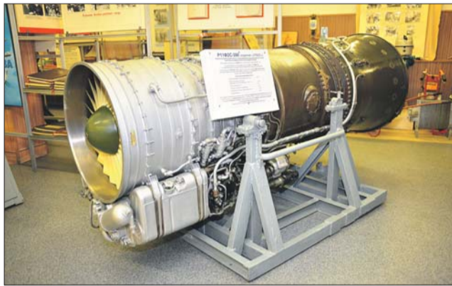
Двигатель Сергея Туманского Р11Ф-300, который на истребителе МиГ-21 позволил установить рекорды скорости и высоты полёта
